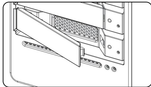
② 取下抽取盒上的原固定架，使用附件包中的硬盘螺丝将硬盘锁在硬盘抽取盒上；再将装载硬盘的抽取盒由上而下依序放入，并推回到底，最后再将把手扣上。
