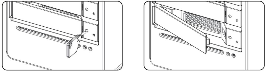
② 取下抽取盒上的原固定架，使用附件包中的硬碟螺絲將硬碟鎖在硬碟抽取盒上；再將裝載硬碟的抽取盒由上而下依序放入，並推回到底，最後再將把手扣上。
